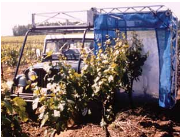
Pulvérisateur adapté à l'épandage des pesticides.
